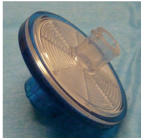
Fig. 23-11 Filtre Millipore. Nécessaire si l'on n'est pas équipé de bouteille stérile de gaz à usage unique, encore de coût élevé.
